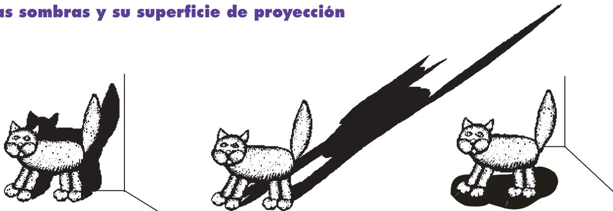
La forma de la sombra proyectada depende del ángulo con el que la luz incide sobre la superficie de proyección. El primer gato recibe luz con dirección horizontal, y su sombra se proyecta sobre una pared. El segundo proyecta su sombra sobre el piso y la luz incide casi horizontalmente. El tercero está iluminado desde arriba y su sombra está debajo de él.
